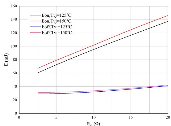
图 5. 开关损耗 逆变器
