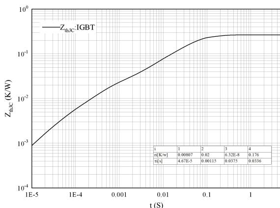
图 11. 瞬态热阻抗 IGBT 逆变器
