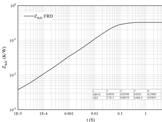
图 12. 瞬态热阻抗 FRD 逆变器
