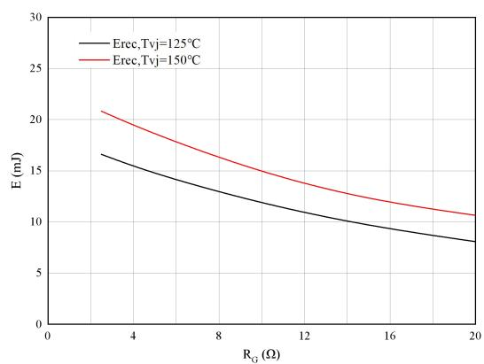
图 7. 开关损耗 二极管
